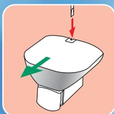
**F** Pour enlever le capot. Faire glisser le capot vers l'avant en insérant un tournevis dans la fente située à l'arrière de l'appareil.
