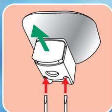
**F** Pour enlever le poussoir. Tirer le poussoir vers soi en insérant un tournevis dans les deux trous inférieurs.
