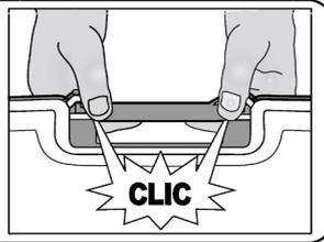
La charnière permet d'ouvrir et de fermer provisoirement le couvercle à chaque remplissage
