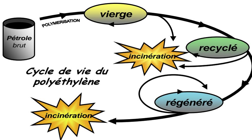
Le polyéthylène utilisé pour la fabrication peut être :
